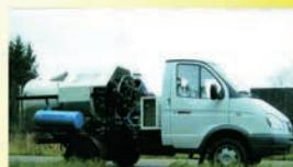
Установка для аэрозольной дезинфекции, дезакаризации и дезинсекции объектов ветеринарного надзора "Аист-2М"
